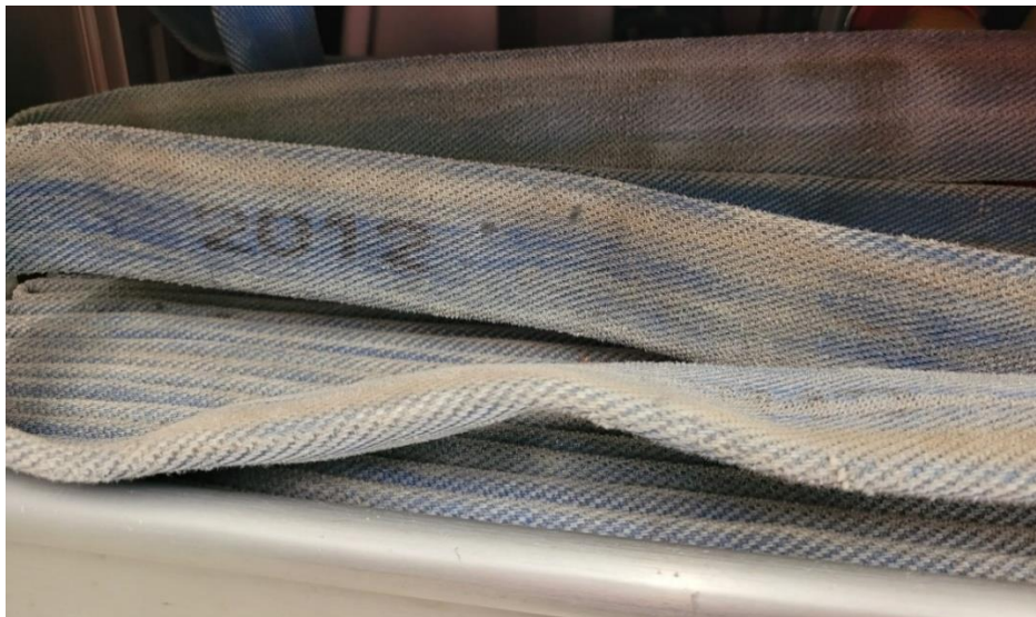
Usure avancée d'un tuyau de notre engin pompe
