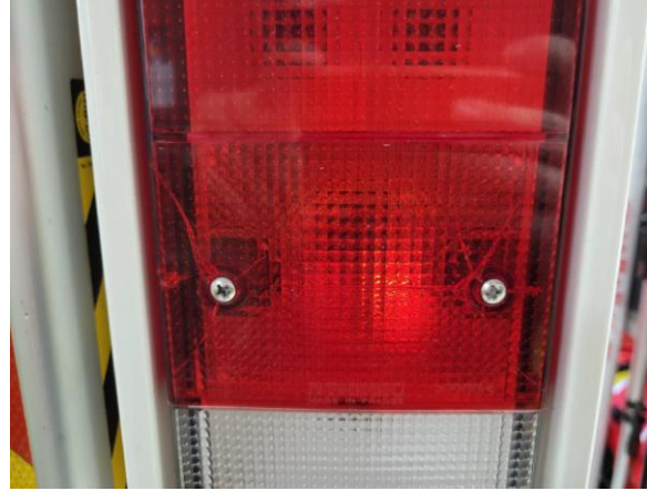
Feu stop fissuré
