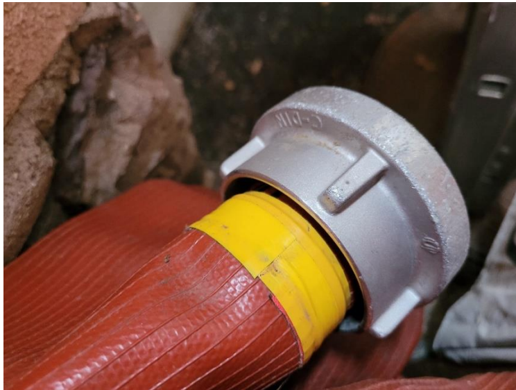
Tuyau rafistolé avec du scotch pour tenir la ligature du tuyau
