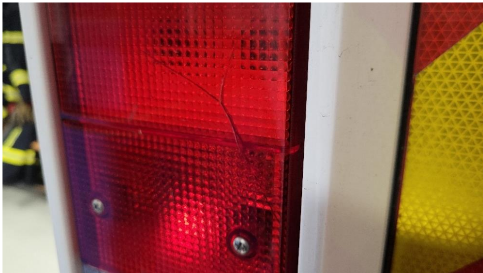
Feu stop fissuré
