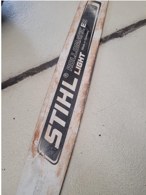
Plateau et chaîne rouillés
