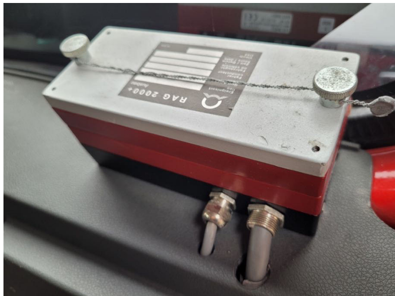
Véhicule 21-15 : Le RAG ne dispose pas des étiquettes de contrôle de validité de l'enregistreur et il n'y a pas de certificat à bord du véhicule
