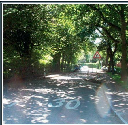
Exemple de resserrement de la chaussée à Chêne-Bougeries - Ch. de l'Ermitage
