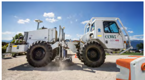
Camion vibreur et capteur «géophone» utilisés lors de la phase de prospection.
